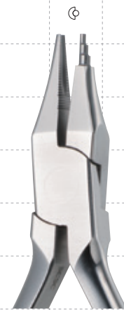
▲ 60-305 ループ フォーミング プライヤー LOOP FORMING PLIER CODE NO.63050 全長：約 125mm Wires up to.022" 医療機器届出番号 09B2X00010000116 一般医療機器・歯科矯正用プライヤ
