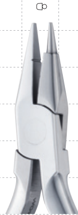
▲ 60-213 ジャラバック プライヤー JARABAK PLIER CODE NO.62130 全長：約 127mm Wires up to.020" 医療機器届出番号 09B2X00010000115 一般医療機器・歯科矯正用プライヤ
